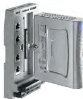
Рис. 5. Простая процедура снятия процессора RTU2020 с модуля IOTA
