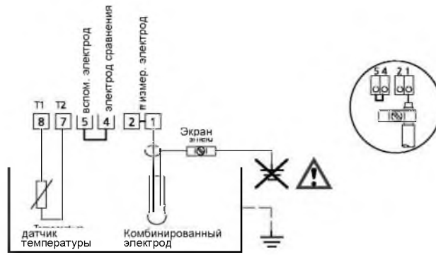
Рис. 11 Измерение pH с помощью комбинированного электрода других производителей, с автономным измерением температуры и функцией Sensoscheck для стеклянного электрода
