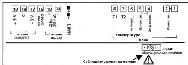
Рис. 6: Распределение клемм датчика ART2000RH-H-00: Класс 1, Разд. 2, Группы A, B, C, D, T4
