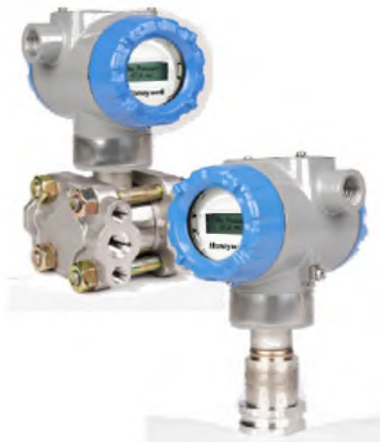
Рисунок 1. Датчики избыточного давления STG700 основаны на проверенной на практике технологии пьезорезистивных элементов
